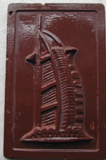
Es.: Tavoletta ricavabile da Stampo di colatura termoformato.
