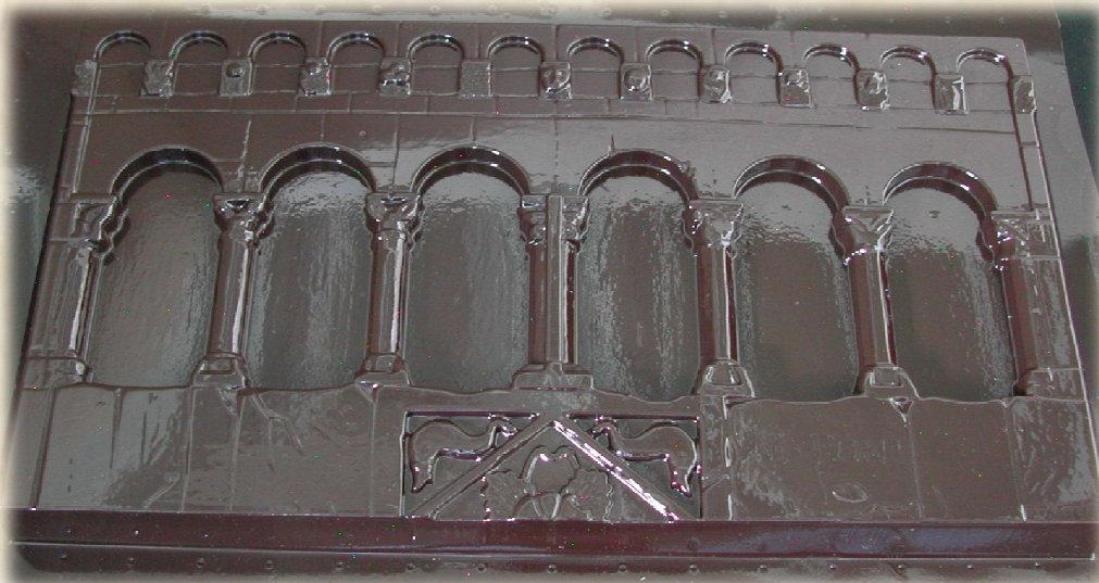
Es.: Sviluppo stampo per corpi cavi, da cui ricavare monumento 3D
