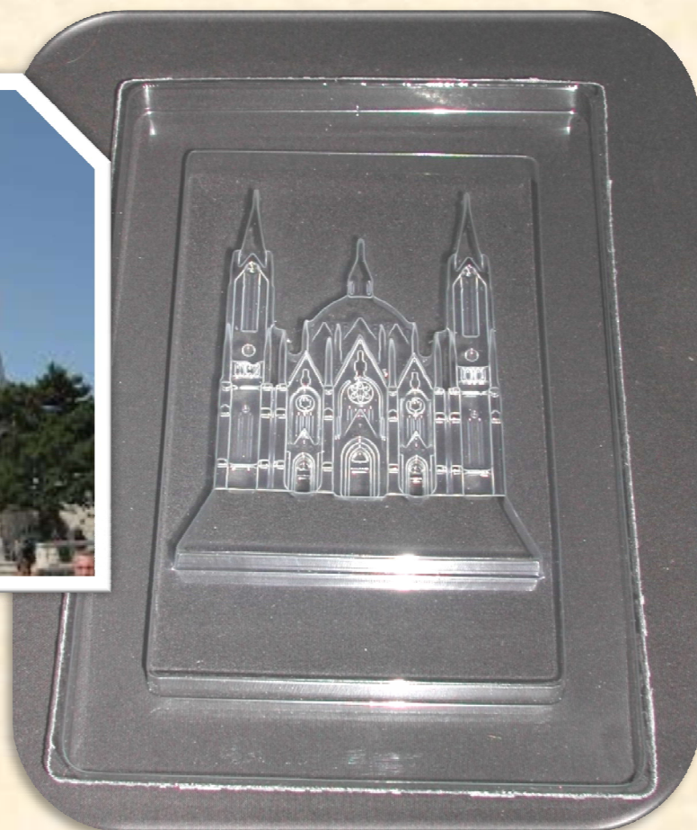
Es.: Riproduzione Tecnica per sviluppo Stampi di colatura
