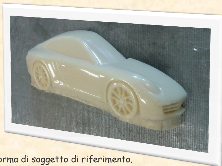
Es.: Riproduzione Tecnica per sviluppo Stampi di colatura
